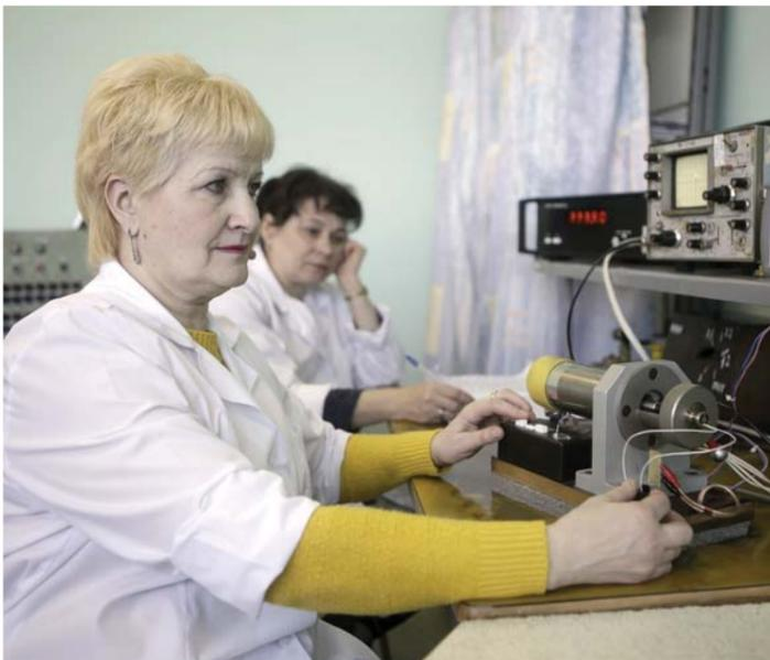
— Нам приносят готовые изделия, которые мы проверяем на работоспособность: делаем замеры скобами, проверяем электрические параметры, — рассказывает Тамара Емельянова. — Если продукция не проходит наш контроль, то мы ее возвращаем обратно. Также продукцию мы испытываем.
